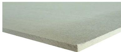
Lastre in gessofibra del tipo "GF-I-W2-C1", sono costituite da gesso e fibre di cellulosa, basso assorbimento d'acqua, 4 bordi a spigolo vivo, densità ca 1150 kg/m<sup>3</sup>, reazione al fuoco A2 -s1, d0, prodotte secondo EN 15283.
