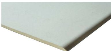
Lastra per la protezione dai raggi X senza piombo, peso ca. 17 kg/m<sup>2</sup>, reazione al fuoco A2 -s1, d0, prodotta secondo EN 520.
