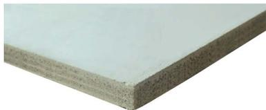
Lastre composte da inerti e cemento Portland, armate con rete in fibra di vetro sulle superfici e rinforzata sugli spigoli (EasyEdge™ \*). Applicazione esterna per il rivestimento di facciate ventilate, controsoffitti esterni ed ambienti interni con presenza elevata di umidità, 4 bordi a spigolo vivo, peso ca. 16 kg/m<sup>2</sup>, reazione al fuoco A1.
