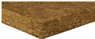
Pannello isolante in lana di roccia dimensionalmente stabile per l'isolamento acustico e termico di pareti divisorie a telaio, reazione al fuoco A1 non combustibile, densità apparente ca. 70 kg/m<sup>3</sup> e resistenza al flusso d'aria > 15 kPa s/m<sup>2</sup>.
