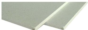
Lastra per sottofondi composta da due lastre in gesso-fibra del tipo "GF-I-W2-C1" da 10 mm o due lastre da 12,5 mm incollate tra loro. Le due lastre sono disposte in modo sfalsato, così da formare una battentatura larga 50 mm. Densità ca. 1150 kg/m<sup>3</sup>, reazione al fuoco A2 -s1, d0, prodotto secondo EN 15283.
