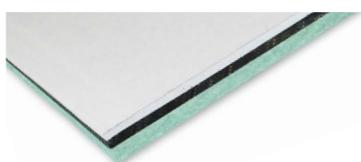
Isolante acustico accoppiato, composto da un pannello di fibra di poliestere da 20 mm (densità ca. 100 kg/m<sup>3</sup>), uno strato in gomma SBR da 8 mm (densità ca. 800 kg/m<sup>3</sup>) e una lastra di gesso rivestito da 13 mm, massa superficiale ca. 18 kg/m<sup>2</sup>. Lavorazione secondo descrizione di posa.
