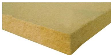
Pannello in fibra di legno ad elevata resistenza alla compressione con uno spessore monostrato omogeneo, per l'isolamento termico sotto pavimento. Carico utile fino 5 kN/m<sup>2</sup>. Valore lambda λD 0,039 W/mK
