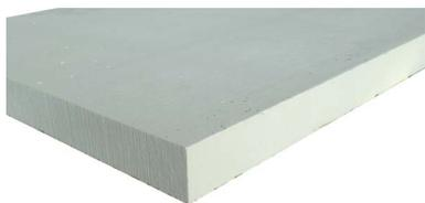
Isolamento interno a base di calcio silicato e cellulosa, per la coibentazione interna delle pareti perimetrali, densità ca 290 kg/m<sup>3</sup> e porosità del 90%. Lavorazione secondo descrizione di posa. Valore lambda  $\lambda_D$  0,053 W/(mK)
