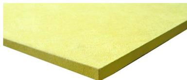
Lastra antincendio costituita da silicati e solfati di calcio, 4 bordi a spigolo vivo, densità ca. 800 kg/m<sup>3</sup>, reazione al fuoco A1, prodotta secondo EN 15283-1.
