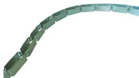
Profilo deformabile per soffitti in acciaio zincato 6/10 del tipo "DX51D-Z140", fori per montaggio da 6 mm, reazione al fuoco A1, prodotto secondo EN 14195.
