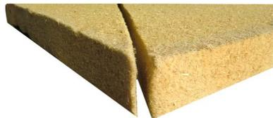
Pannello isolante in fibra di legno flessibile ed ecologico, per l'isolamento termico in intercapedine di strutture a telaio nonché per l'isolamento di pareti divisorie a telaio e contropareti, densità apparente ca. 50 kg/m<sup>3</sup> e reazione al fuoco E.
