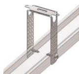
Staffa regolabile per fissare i profili CD 60x27 mm – registrabile fino a 120/200 mm, portata 0,40 kN EN 13964.
