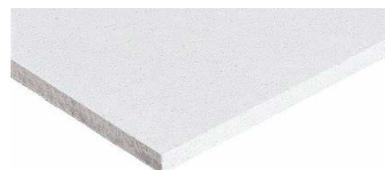
Lastra antincendio in gessofibra del tipo "GF-I-W2-C1", rinforzata con fibre di cellulosa e fibre minerali incombustibili, idrofobata, 4 bordi a spigolo vivo, densità ca. 1.200 kg/m<sup>2</sup>, reazione al fuoco A1, prodotta secondo EN 15283.
