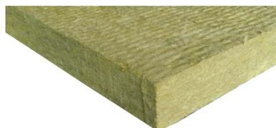
Pannello isolante in lana di roccia dimensionalmente stabile per l'isolamento acustico e termico di pareti divisorie a telaio, reazione al fuoco A1 non combustibile, densità apparente ca. 70 kg/m<sup>3</sup>.
