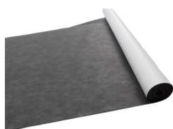
Telo di tenuta al vento aperto alla diffusione composto da tre strati di polipropilene per la posa diretta sul coibente o sul tavolato. Nastrare con Airstop flex, valore sd 0,02m.
