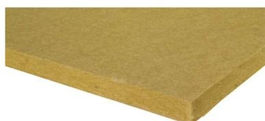
Pannello in fibra di legno ad elevata resistenza alla compressione, per l'isolamento termico sotto pavimento, resistenza alla compressione > 150 kPa. Valore lambda λD 0,046 W/mK
