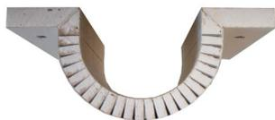
Lastra di gesso rivestito, con fresatura longitudinale del tipo "A" per la realizzazione di elementi curvi con piccolo raggio, prodotta secondo EN 520.
