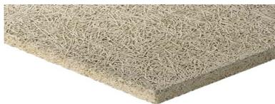
Pannello acustico in lana di legno, legato con magnesite, elegante struttura superficiale, consigliato per la bioedilizia con eccellenti proprietà fisico-tecniche in termini di protezione antincendio e acustica, reazione al fuoco B-s1, d0.
