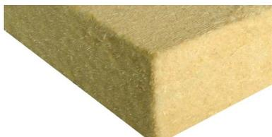
Pannello in fibra di legno ecologico (certificato naturplus), con spessore monostrato omogeneo, per la coibentazione interna delle pareti perimetrali, densità ca. 130 kg/m<sup>3</sup>, reazione al fuoco E. Lavorazione secondo descrizione di posa.
