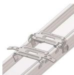
Clip per fissare i profili CD 60x27 mm direttamente sul soffitto, portata 0,40 kN se il profilo viene fissato lateralmente con due viti e 0,25 kN senza fissaggio laterale – EN 13964.
