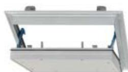
Botole di ispezione per controsoffitti tagliafuoco EI60, con telaio in alluminio anodizzato e coperchio interno apribile a ribalta, completamente rimovibile.
