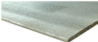
Lastre in cemento alleggerito fibrorinforzato composte da un nucleo in cemento Portland additivato con inerti, fibrorivestite sulle due facce con uno strato di rete in fibra di vetro, per uso esterno ed ambienti interni con presenza elevata di umidità, con bordi longitudinali assottigliati, peso ca 14,2 kg/m<sup>2</sup>, reazione al fuoco A1. (Lastra flex per la realizzazione di elementi curvi, raggio di curvature 15 cm)
