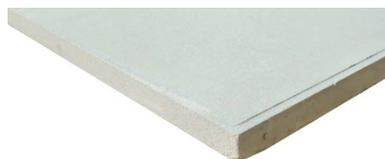
Lastre antincendio in gesso rinforzato le cui superfici e bordi longitudinali sono rivestiti da uno speciale tessuto di fibre di vetro, 4 bordi a spigolo vivo, densità ca 780 kg/m<sup>3</sup>, reazione al fuoco A1, prodotte secondo EN 15283-1.
