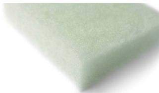
Feltro isolante in poliestere ecologico, realizzato con materiale riciclato. Per l'isolamento termico e acustico di pareti divisorie a telaio e controsoffitti, reazione al fuoco B- s2, d0.
