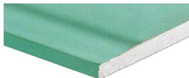
Lastre di gesso rivestito a basso assorbimento d'acqua del tipo "H2" (ripresa d'acqua totale ≤ 10%) con bordi longitudinali assottigliati e reazione al fuoco A2 -s1, d0, prodotte secondo EN 520.
