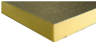
Pannello in poliuretano rigido PUR/PIR, rivestito con una barriera al vapore in alluminio su entrambi i lati, per la coibentazione interna delle pareti perimetrali, reazione al fuoco E. Lavorazione secondo descrizione di posa. Valore lambda  $\lambda_D$  0,023 W/(mK)
