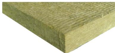
Pannello isolante in lana di roccia dimensionalmente stabile per l'isolamento acustico e termico di pareti divisorie a telaio, reazione al fuoco A1 non combustibile, densità apparente ca. 40 kg/m<sup>3</sup> e resistenza al flusso d'aria > 12 kPa s/m<sup>2</sup>.
