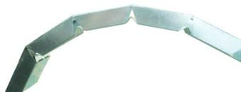
Profili a C deformabili per soffitti in acciaio zincato 6/10 del tipo "DX51D-Z140", disponibile concave e convesse, reazione al fuoco A1, prodotto secondo EN 14195.
