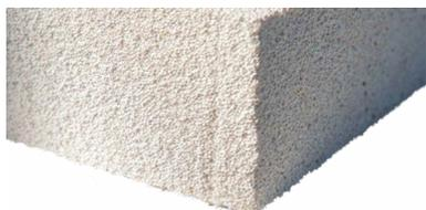
Pannello minerale ecologico a base di calce, sabbia e agente areante, per la coibentazione interna delle pareti perimetrali, densità ca. 115 kg/m<sup>3</sup> e porosità > 95%. Lavorazione secondo descrizione di posa. Valore lambda  $\lambda_D$  0,043 W/(mK)
