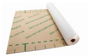
Freno al vapore in carta rinforzata, elevata resistenza allo strappo, per tetti, pareti e soffitti. Il vapore acqueo può diffondere attraverso l'isolamento termico in modo controllato e misurato. Nastrare con Airstop Elasto. Valore sd 6,45m.
