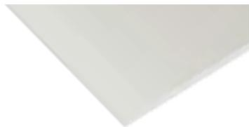
Lastra speciale in cartongesso per esterno ed ambienti interni con presenza elevata di umidità del tipo "GM F H1 I" (ripresa d'acqua totale  $\leq 5\%$ ), esponente alle intemperie fino a 6 mesi, peso ca. 12 kg/m<sup>2</sup>, con bordi longitudinali assottigliati e reazione al fuoco A1, prodotta secondo EN 15283-1.
