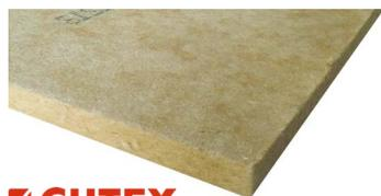
Pannello in fibra di legno anticalpestio, adatto per sottofondi a secco e massetti tradizionali, carico utile fino 5 kN/m<sup>2</sup> e rigidità dinamica < 30 MN/m<sup>3</sup>.
