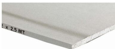
Lastra di gesso rivestito standard del tipo "A" con bordo trasverso assottigliabile in applicazione e reazione al fuoco A2 -s1, d0, prodotta secondo EN 520.
