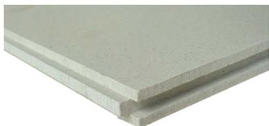
Lastra in gessofibra del tipo "GF-I-W2-C1", è costituita da gesso e fibre di cellulosa, basso assorbimento d'acqua, 4 bordi maschio/femmina, consigliata per la bioedilizia da IBR, densità ca 1100 kg/m<sup>3</sup>, reazione al fuoco A2 -s1, d0, prodotta secondo EN 15283.
