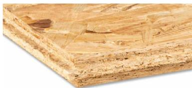
L'OSB 3 (Oriented Strand Board) è un pannello high-tech in legno naturale, costituito da trucioli lunghi e sottili disposti trasversalmente in due strati esterni e uno strato intermedio, con elevata resistenza alla flessione, per scopi non portanti, portanti e di irrigidimento in ambienti asciutti e umidi secondo la norma DIN EN 13986 o EN 300.
