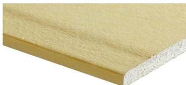
Lastra speciale in cartongesso per esterno ed ambienti interni con presenza elevata di umidità del tipo "GM F H1 I" (ripresa d'acqua totale ≤ 3%), esponibile alle intemperie fino a 6 mesi, peso ca. 11 kg/m<sup>2</sup>, con bordi longitudinali assottigliati e reazione al fuoco A1, prodotta secondo EN 15283-1.
