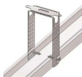
Staffa universale per fissare i profili CD 27x50 e 15x50 mm, regolabile fino a 120 mm, portata 0,4 kN EN 13964.
