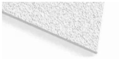
Pannelli per controsoffitto composti da lana minerale, perlite, argilla e amido e presentano ottime caratteristiche antincendio e per l'acustica, reazione al fuoco A2 -s1, d0, prodotto secondo EN 13964
