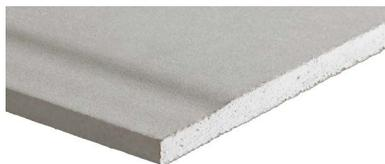
Lastre di gesso rivestito standard del tipo "A" con bordi longitudinali assottigliati e reazione al fuoco A2 -s1, d0, prodotte secondo EN 520.
